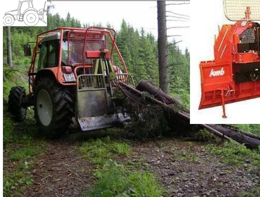
**(Traktor) mit Seilwinde**
